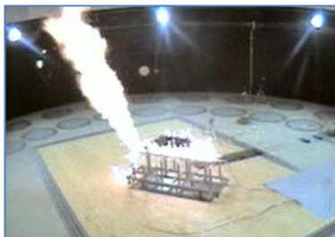
圧縮水素ガス容器の火炎暴露試験
