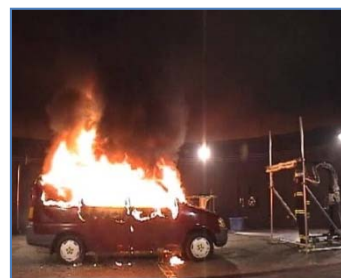
熱流束計を使用した 火災試験による火傷評価
