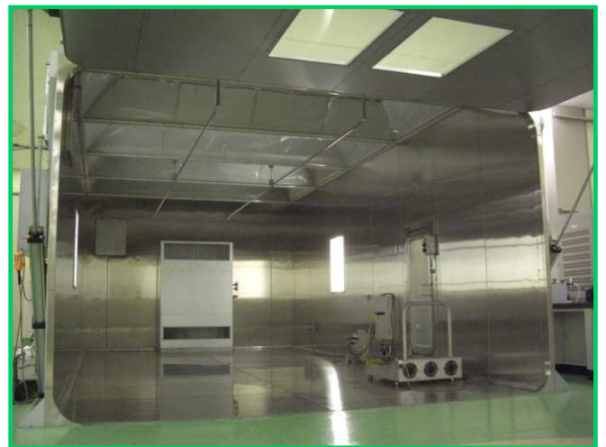
ガソリン自動車の蒸発ガス試験装置
