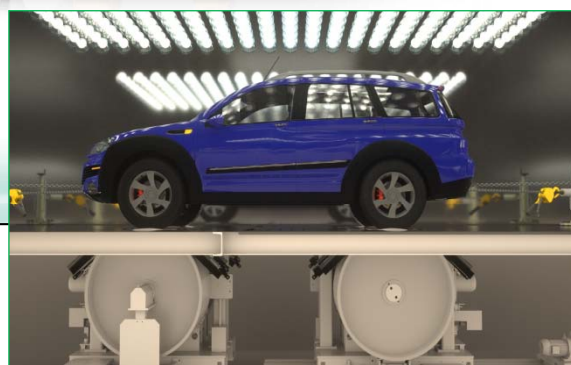
環境型_小型車用シャシダイナモメータ(イメージ) (日射装置付_稼動:2018年4月~)
