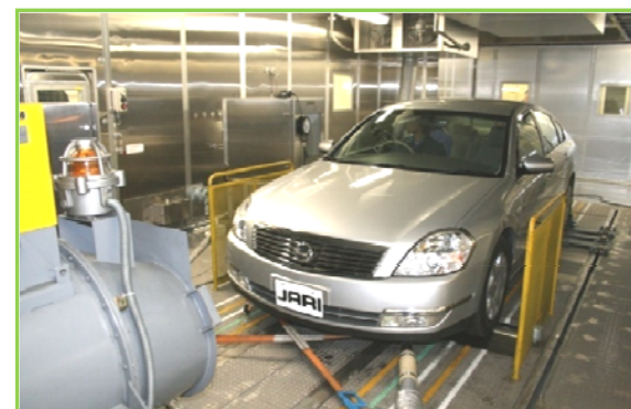
環境型_小型車用シャシダイナモメータ (蒸発ガス評価機能付)
