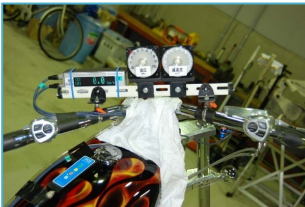
二輪車 モニターメータ (速度、操作力、減速度)
