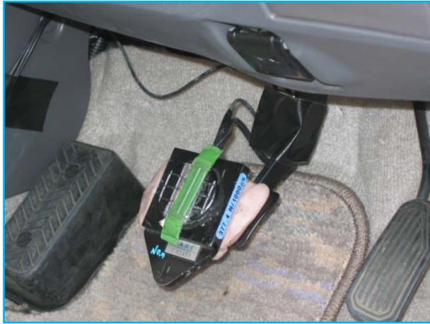
踏力計及びブレーキ開始トリガ用テープスイッチ
