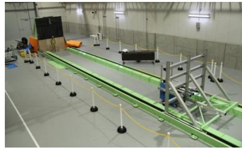
Fig. 3 ロボット用衝突試験システム
