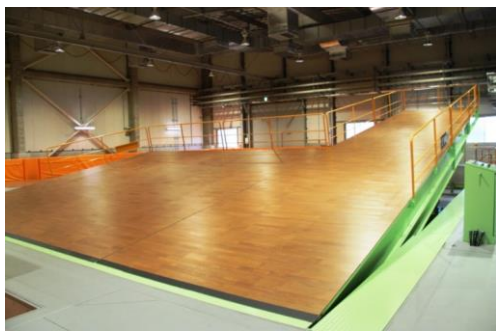
Fig. 2 傾斜走行試験路(フローリング路面仕様)
